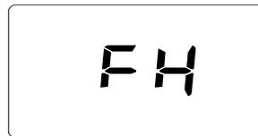
fig. 6- Purgé avec ventilateur activé
